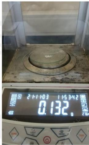
Di Timbang  $(\text{NH}_4)_2\text{HPO}_4$
