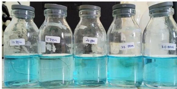
Hasil uji fotodegradasi *methylene blue* dengan fotokatalis  $\text{Ag}_3\text{PO}_4$  pada variasi konsentrasi 10, 15, 20, 25, dan 30 ppm (dari kiri ke kanan)
