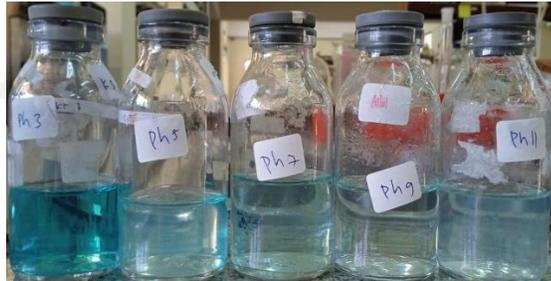
Hasil uji fotodegradasi *methylene blue* dengan fotokatalis  $\text{Ag}_3\text{PO}_4$  pada variasi pH 3, 5, 7, 9, dan 11 (dari kiri ke kanan)
