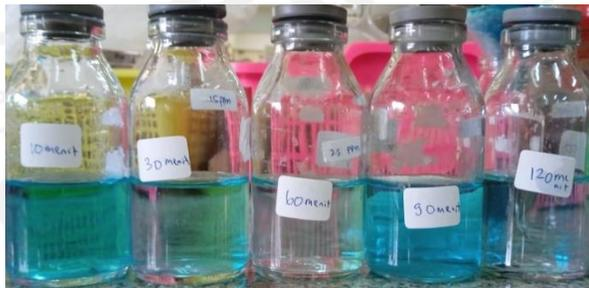
Hasil uji fotodegradasi *methylene blue* dengan fotokatalis  $\text{Ag}_3\text{PO}_4$  pada variasi waktu kontak 10, 30, 60, 60, dan 120 menit (dari kiri ke kanan)
