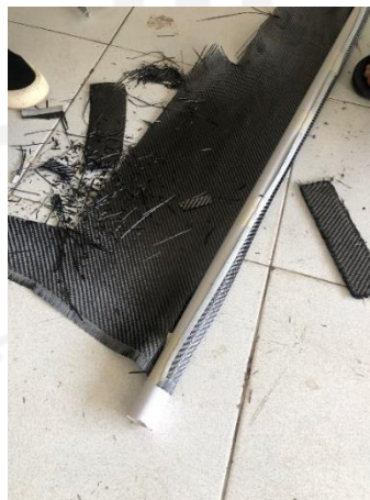
Gambar 3. 11 Proses pemotongan carbon fiber
