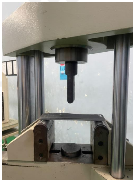
Gambar 4. 1 Peletakan Spesimen Pada Proses Pengujian
