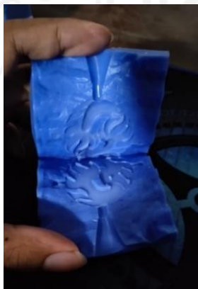
Gambar 4. 10 Hasil Cetakan Silikon
