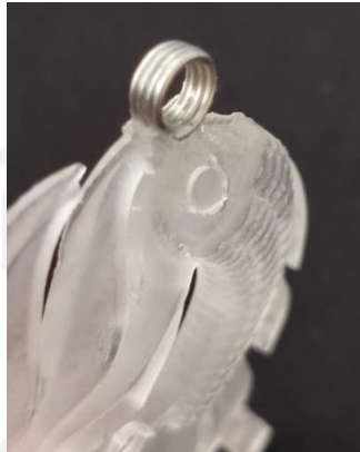
Gambar 4. 9 Perbaikan Hoop Liontin
