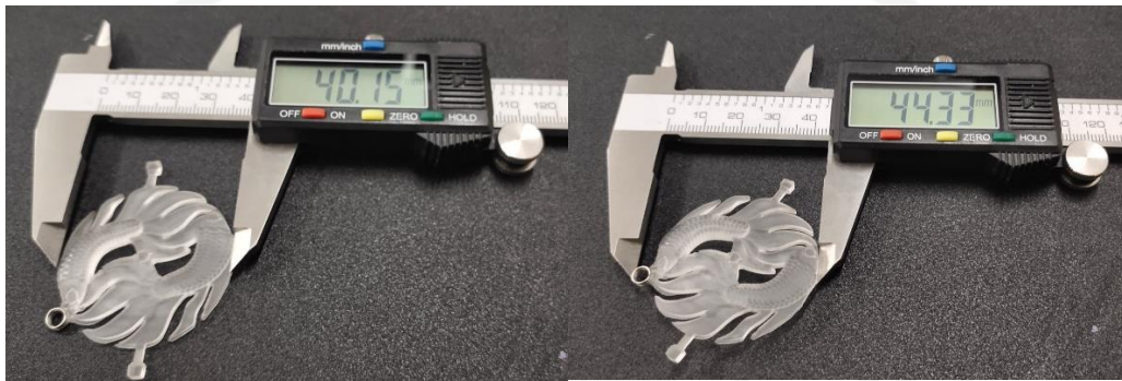
Gambar 4. 7 Kesesuaian Kriteria Desain dengan Hasil CNC
