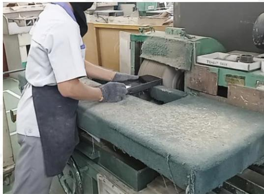
Gambar 3-3 Pengoperasian Manual Pada Mesin *Edge Buff*
