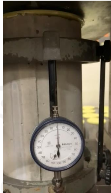
Gambar 5.12 Pengujian Kuat Tekan
