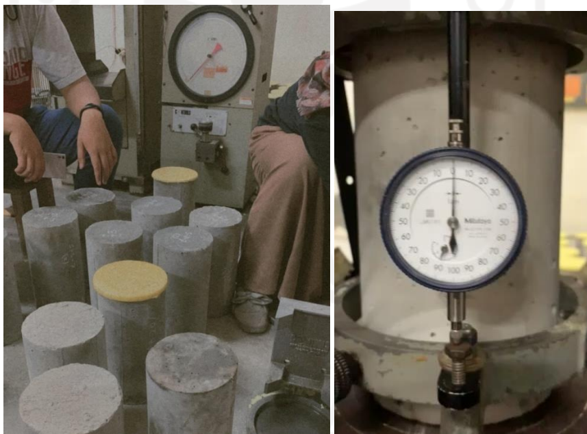
Gambar L-4.2 Proses Pengujian Kuat tekan dan Modulus Elastisitas Beton
