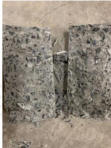
Gambar 5.19 Contoh Benda Uji dari Hasil Pengujian Kuat Tarik Belah
