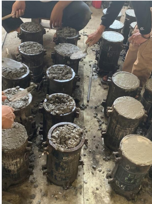
Gambar L-3.8 Proses Memasukan campuran beton kedalam cetakan
