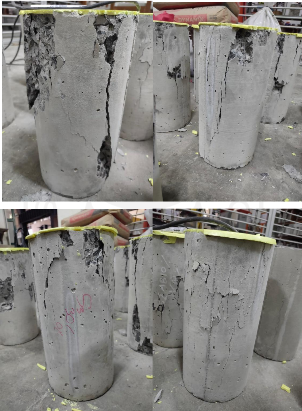
Gambar L-4.3 Hasil Proses Pengujian Kuat Tekan
