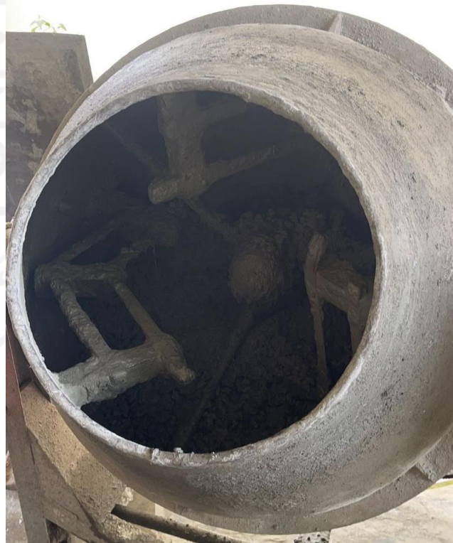
Gambar L-3.5 Proses Pembuatan Campuran beton
