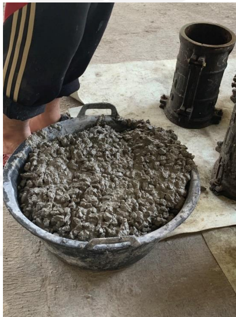
Gambar L-3.7 Proses penuangan campuran beton kedalam ember
