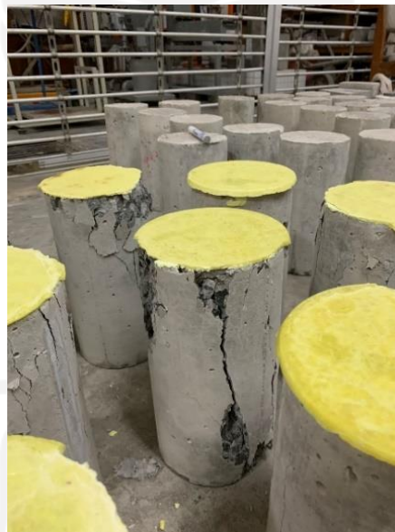
Gambar 5.13 Contoh Benda Uji dari Hasil Pengujian Kuat Tekan
