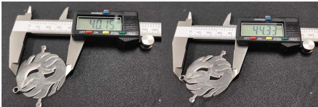
Gambar 4. 7 Kesesuaian Kriteria Desain dengan Hasil CNC
