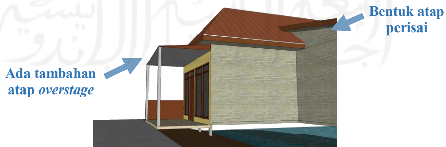
Gambar 4. 39 Atap rumah vernakular akulturasi Bugis atap perisai memiliki nilai efisiensi embodied energy paling rendah karena bentuk atap perisai dan adanya atap tambahan overstage pada teras
