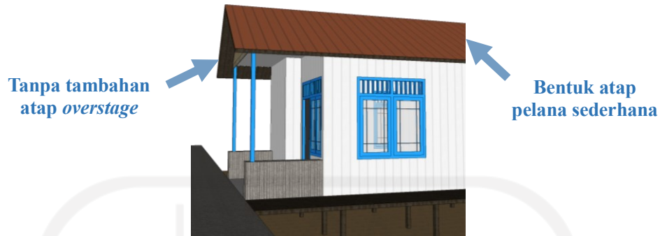
Gambar 4. 38 Atap rumah vernakular akulturasi Jawa memiliki nilai efisiensi embodied energy paling tinggi karena bentuk atap pelana sederhana dan tanpa adanya atap overstage pada teras
