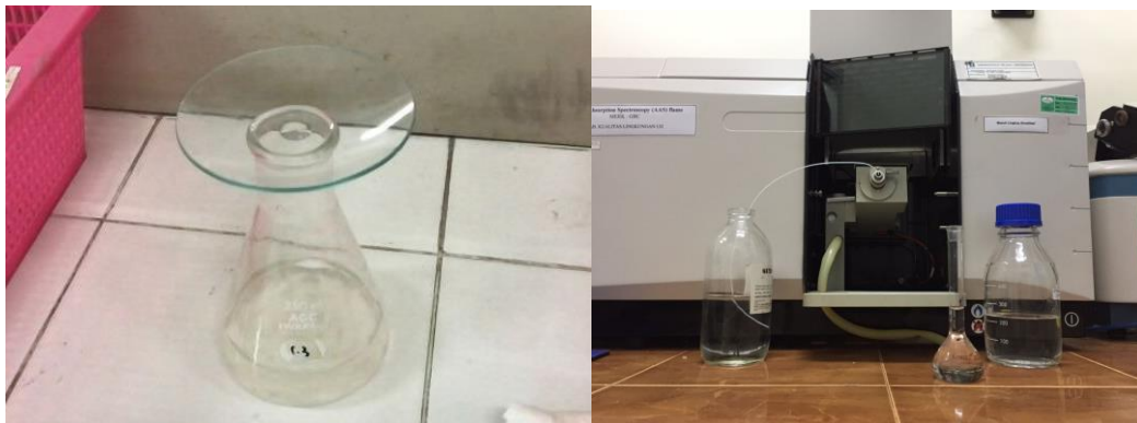
Gambar 4. 4 Uji Timbal dengan Metode Destruksi Basah
