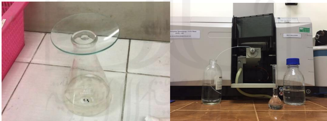
Gambar 4. 4 Uji Timbal dengan Metode Destruksi Basah
