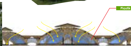
PERANCANGAN PADA GREENHOUSE DIBUAT TERBUKA DENGAN MATERIAL PENUTUP ATAP PLASTIK UV, AKAN DIGUNAKAN UNTUK PEREBITAN DENGAN MEMAKSIMALKAN PENCAHAYAN ALAM
