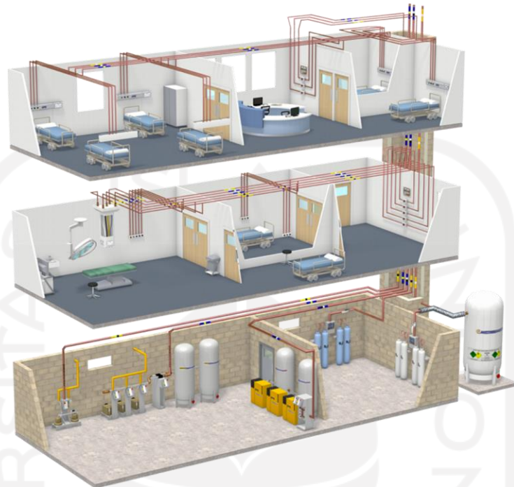
Gambar 1. 3 Skema instalasi gas medik dan vakum medik rumah sakit
