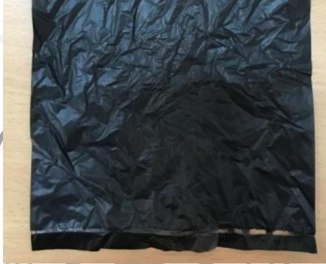
Gambar V.2 Gambar jenis cacat kantong berlubang
