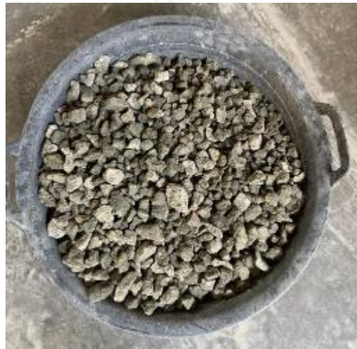
Gambar L-2.5 Agregat Halus, Breksi Batu Apung
