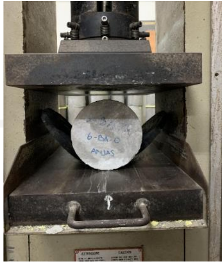
Gambar L-3.10 Proses Pengujian Kuat Tarik Belah Beton
