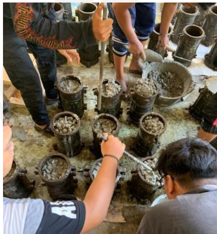
Gambar L-3.5 Pemasukan Beton pada Cetakan
