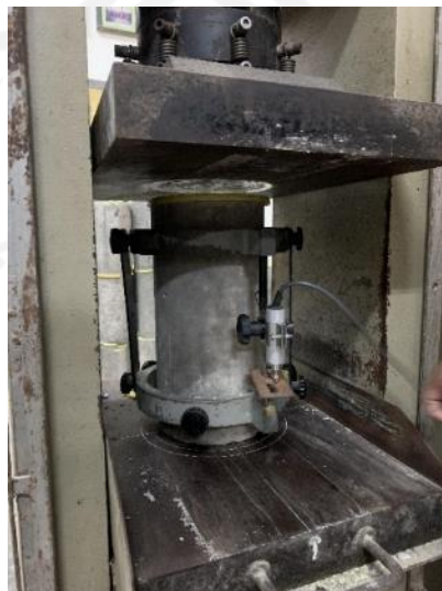
Gambar L-3.9 Proses Pengujian Kuat Tekan dan Modulus Elastisitas Beton
