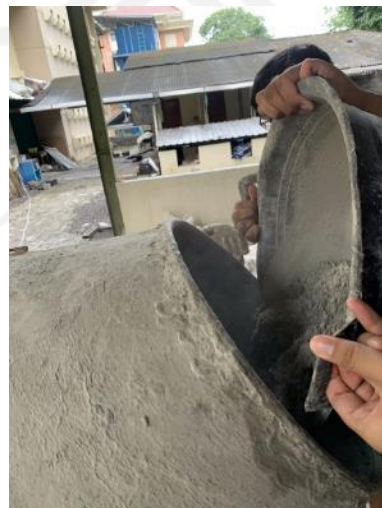
Gambar L-3.3 Pencampuran Material Penyusun Beton
