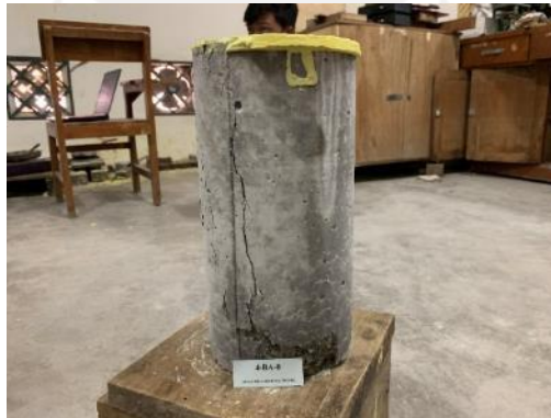
Gambar L-3.11 Hasil Pengujian Kuat Tekan dan Modulus Elastisitas Beton
