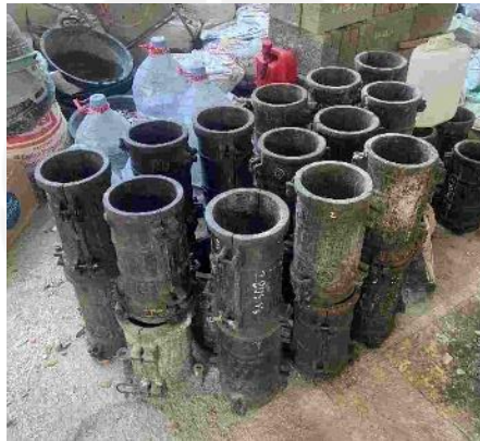
Gambar L-1.8 Cetakan Silinder Beton
