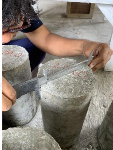
Gambar L-3.7 Pengukuran Dimensi Benda Uji
