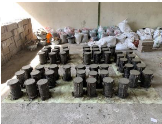
Gambar L-3.6 Hasil Proses Pembuatan Benda Uji
