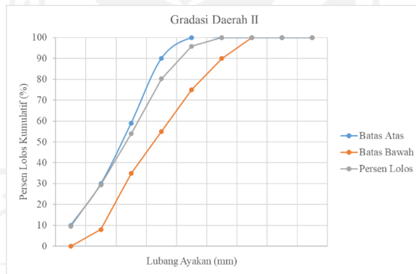
Gambar 5.1 Gradasi Agregat Halus Sampel 1 Daerah II
