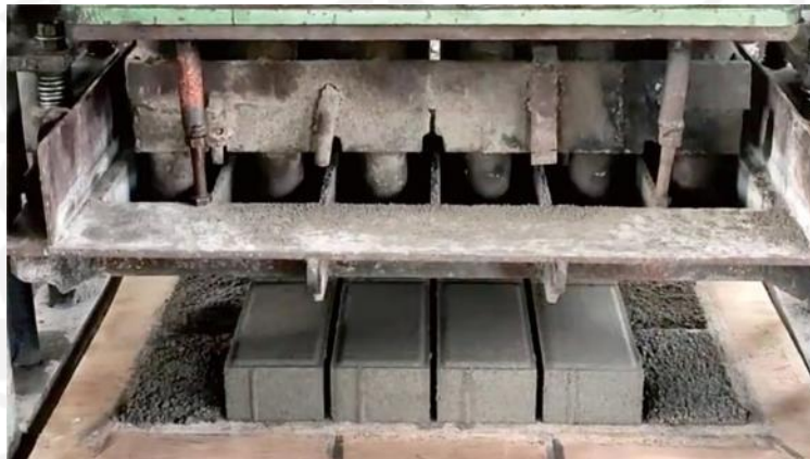
Gambar L-4.2 Proses Pembuatan Benda Uji
