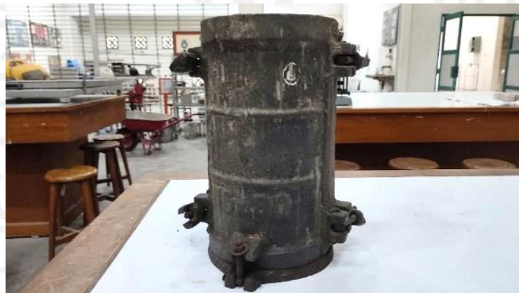
Gambar L-1.6 Cetakan Silinder Beton
