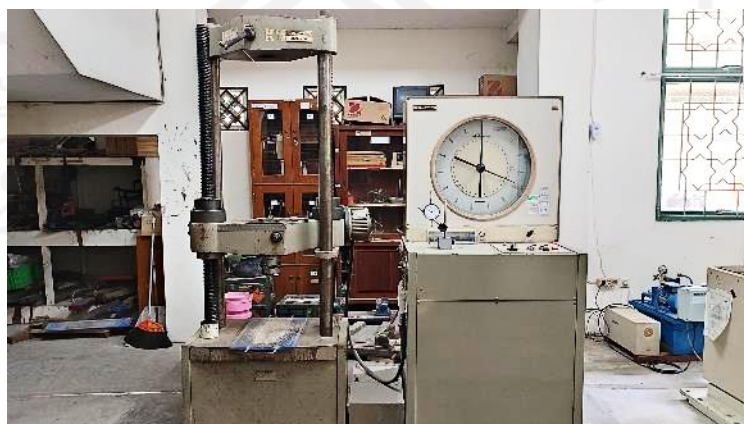
Gambar 4.11 Mesin Uji Kuat Tekan Paving Block
