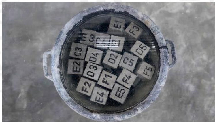
Gambar L-5.3 Proses Pengujian Penyerapan Air Paving Block
