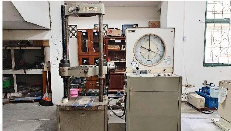
Gambar L-1.10 Mesin Uji Kuat Tekan Paving Block
