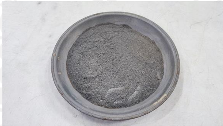
Gambar L-2.2 Abu Serbuk Kayu Mahoni Sesudah Dilakukan Pembakaran dan Penyaringan
