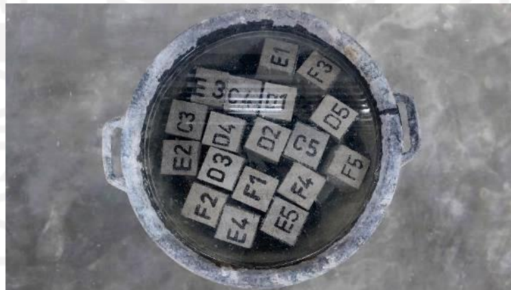
Gambar 5.9 Pengujian Penyerapan Air Paving Block
