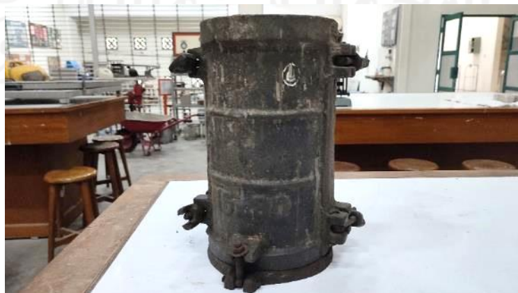
Gambar 4.7 Cetakan Silinder Beton
