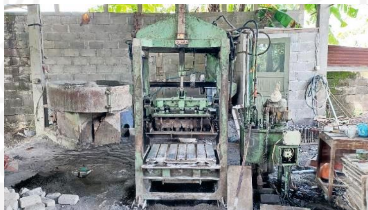
Gambar L-1.8 Mesin Cetak Paving Block
