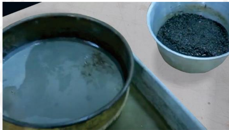
Gambar L-3.5 Pemeriksaan Butiran Yang Lolos Ayakan No. 200 / Uji Kandungan Lumpur Dalam Pasir
