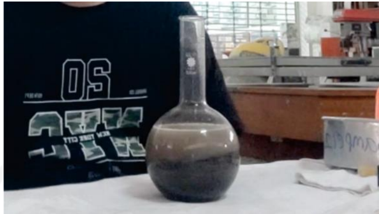
Gambar L-3.1 Pemeriksaan Berat Jenis dan Penyerapan Air Agregat Halus
