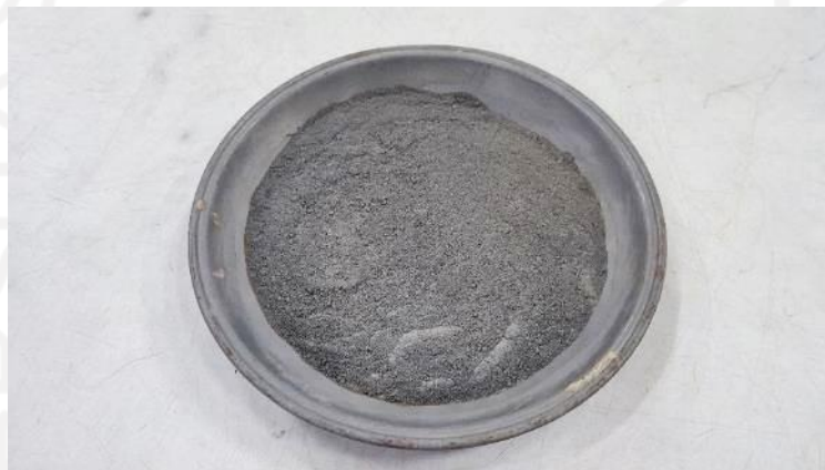
Gambar 4.14 Abu Serbuk Kayu Mahoni Sesudah Dilakukan Pembakaran dan Penyaringan
