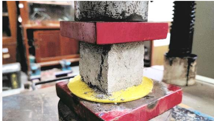
Gambar L-5.1 Proses Pengujian Kuat Tekan Paving Block
