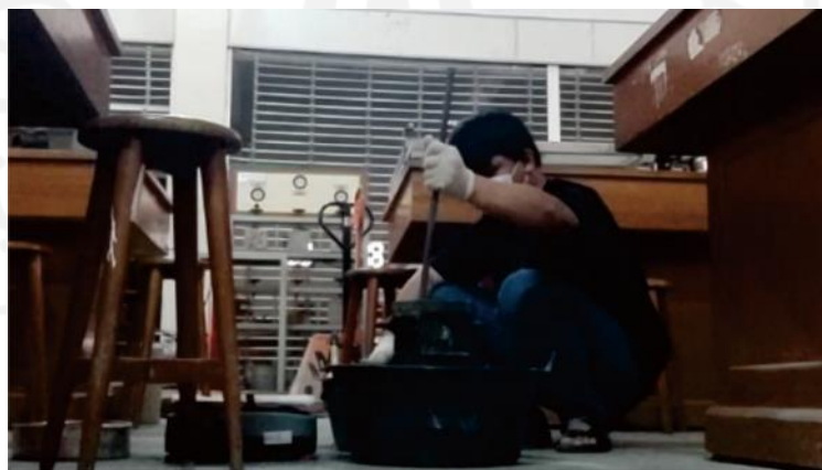
Gambar L-3.3 Pemeriksaan Berat Isi Padat Agregat Halus
