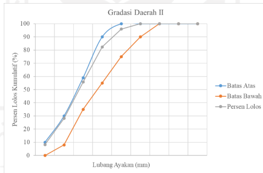
Gambar 5.2 Gradasi Agregat Halus Sampel 2 Daerah II
