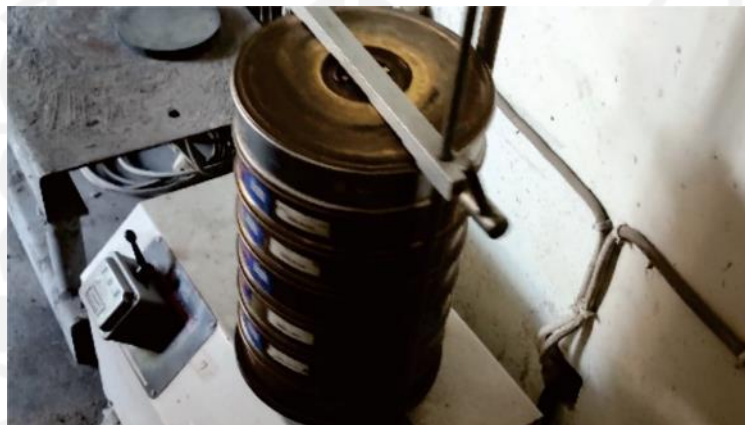
Gambar L-3.2 Modulus Halus Butir (MHB) / Analisis Saringan Agregat Halus
