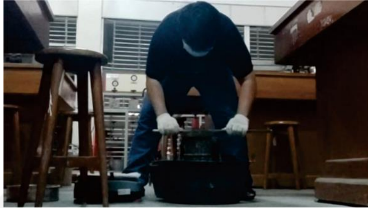
Gambar L-3.4 Pemeriksaan Berat Isi Gembur Agregat Halus
