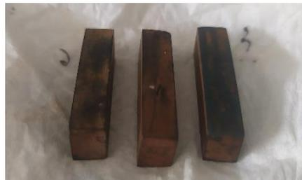
**Gambar 3- 5 Hasil Spesimen Nitridasi**
