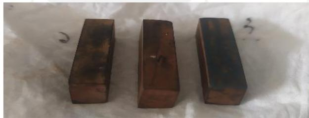
**Gambar 4- 1** Spesimen *Sprocket* Hasil Proses Nitridasi
