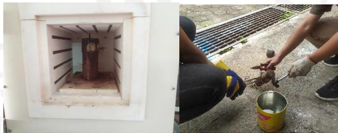
**Gambar 3- 4 Proses dimasukkan tabung dalam *furnace* dan pendinginan cepat**
