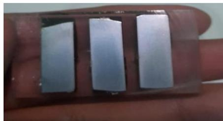
Gambar 3- 9 Spesimen Pengamatan Struktur Mikro
