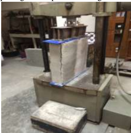
Gambar 6 Pengujian kuat tekan dinding pasangan bata plesteran dengan kawat
