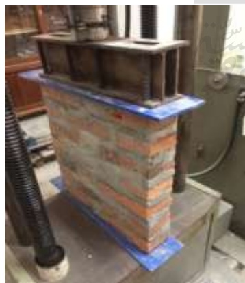
Gambar 2 Pengujian kuat tekan dinding pasangan bata tanpa plesteran
