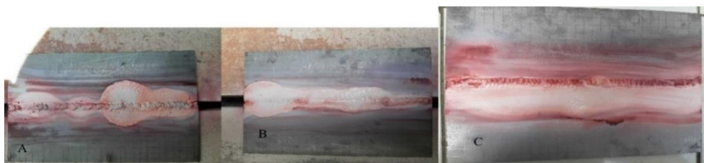
Gambar 4.4 Hasil pengujian Dye Penetrant a. elektroda lurus, b. elektroda spiral, c. elektroda zig – zag
