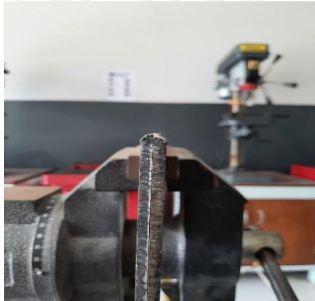
Gambar 3.3 Proses Pembuatan Kampuh
