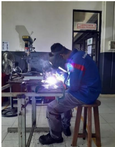
Gambar 3.4 Proses Pengelasan Spesimen uji
