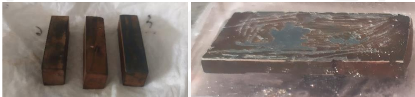
Gambar 4-1 Hasil spesimen setelah proses nitridasi
