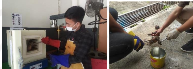
Gambar 3-7 Proses pengeluaran tabung dan pendinginan cepat
