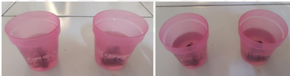
Gambar 3-13 Uji spesimen laju korosi
