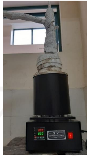
Proses pirolisis tempurung kelapa sawit hasil impregnasi disuhu 800\text{ }^\circ\text{C}
