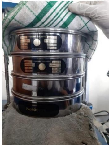
Melakukan pengayakan dengan bantuan sieve shaker
