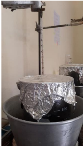
Proses impregnasi dengan larutan \text{H}_3\text{PO}_4 65%
