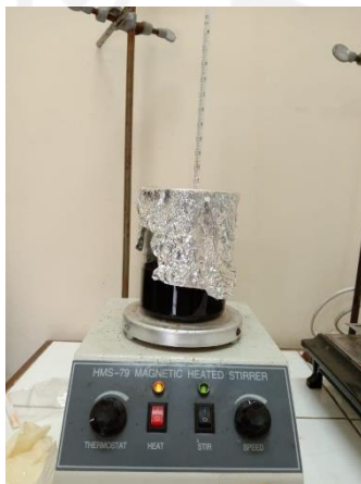
Proses modifikasi KA dengan \text{HNO}_3 1M
