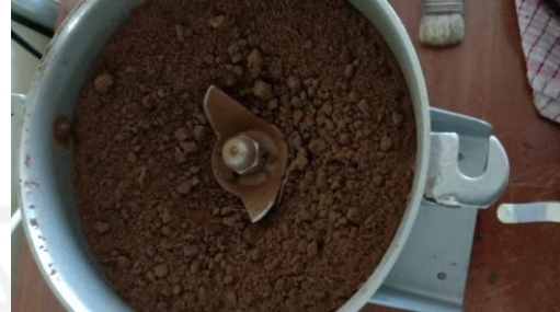
Melakukan grinder tempurung kelapa sawit dengan ZT-300 Herb
