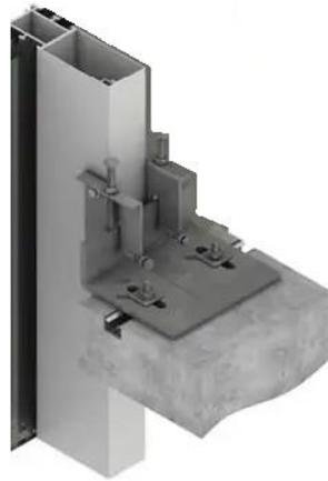
**Gambar 3.6 Pemasangan Aluminium Mullion Vertikal**
