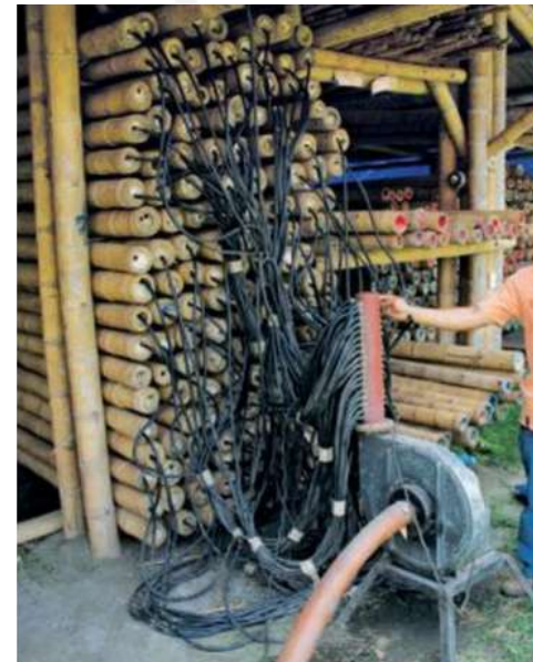
Gambar 2.2 Injeksi angin pada bambu
