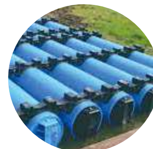
Drum Plastik Diikat Ke Rangka Rakit dengan Plat Baja.
