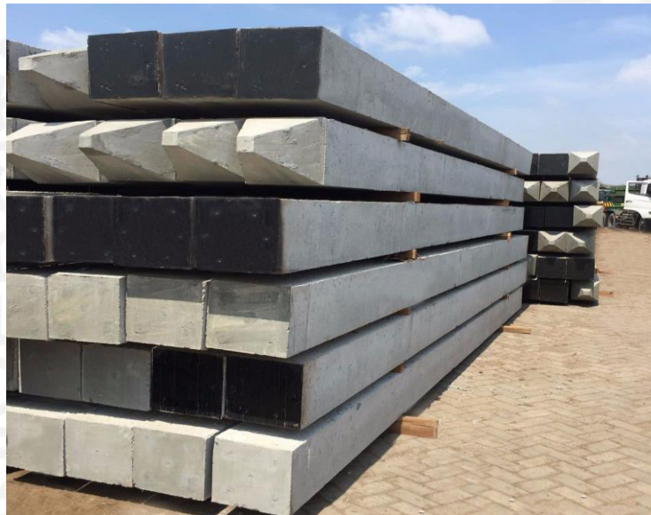
Gambar 3.3 Tiang Pancang Segiempat ( square pile )
