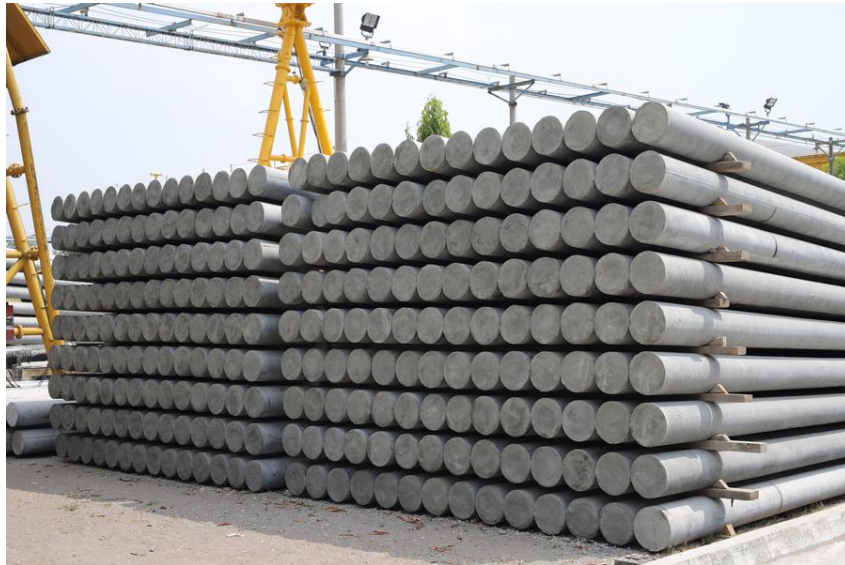
Gambar 3.5 Tiang Pancang Lingkaran Pejal
