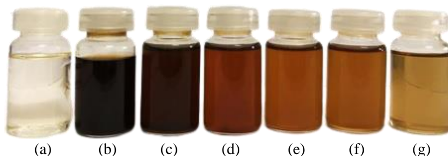
Gambar 30. Visual EO-AgNPs dari variasi konsentrasi minyak serai wangi (a) minyak serai (b) 10 mM (c) 5 mM (d) 3,3 mM (e) 2,5 mM (f) 2,0 mM dan (g) 1,6 mM
