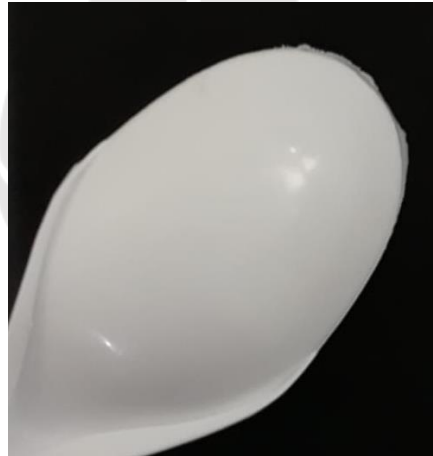
Jenis Cacat Flashing
