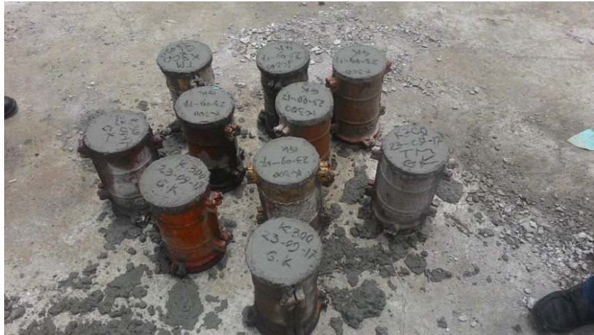
Gambar L-10.2 Sampel Campuran Beton
