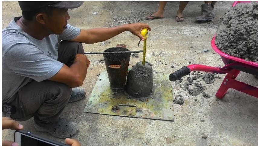
Gambar L-10.3 Uji Slump Beton
