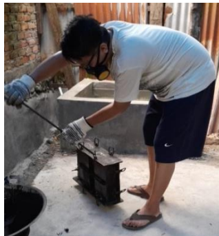
Gambar 14. Proses pemadatan manual lelehan plastik
