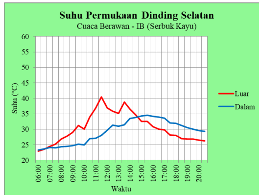
Gambar 66. Grafik suhu permukaan dinding selatan IB-Sawdust saat cuaca berawan
