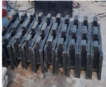
Gambar 16. Interlock brick yang dikeringkan setelah proses perendaman
