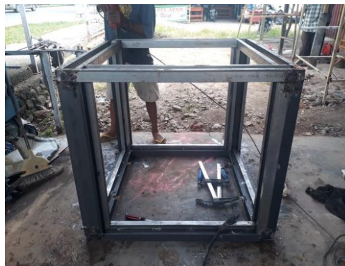
Gambar 19. Rangka struktur prototype dari bahan besi hollow
