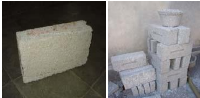
Gambar 6. Batako dan Bata dari Styrofoam Sumber : Rifany dan Rizal (2011)
