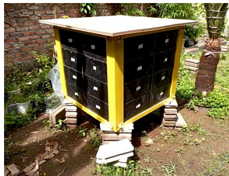
Gambar 22. Prototype interlock brick dari daur ulang sampah plastik
