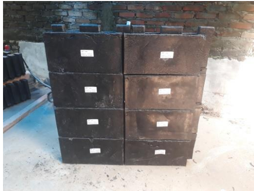
Gambar 20. Bidang dinding interlock brick dari bahan daur ulang sampah plastik
