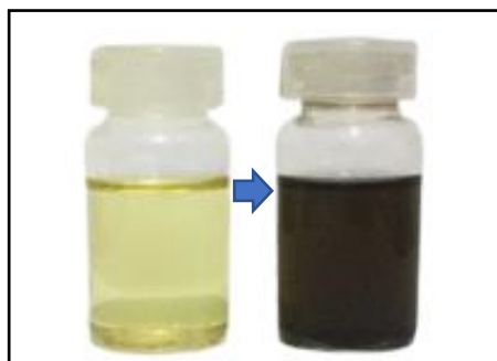
Gambar 17. Sintesis EO-AgNPs secara langsung
