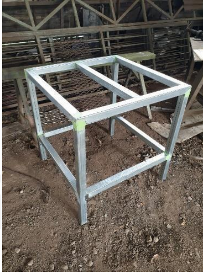
Gambar 4-19 Rangka Meja Perakitan
