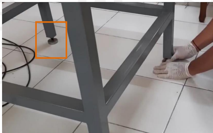
Gambar 4-20 Proses Mengatur Ketinggian Meja Perakitan
