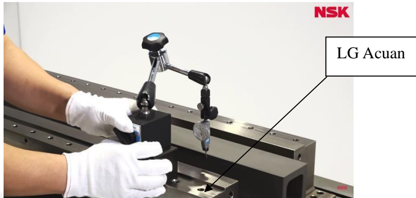
Gambar 4-7 Verifikasi Kelurusan LG Acuan menggunakan straight edge Sumber: NSK Assembly Linier Guide
