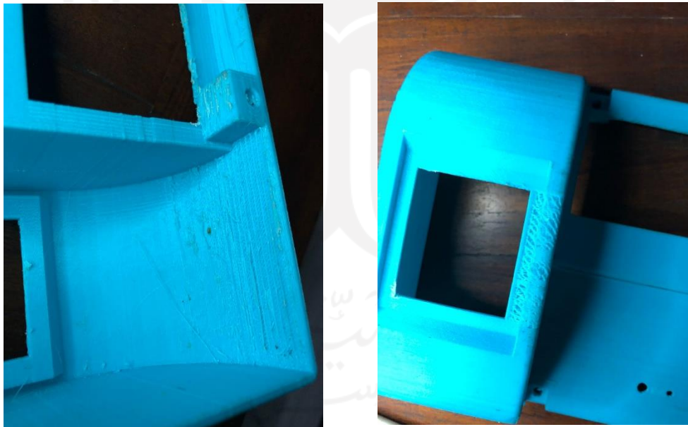
Gambar 4. 11 Kegagalan Hasil Print Tutup Kotak MCB Pertama
