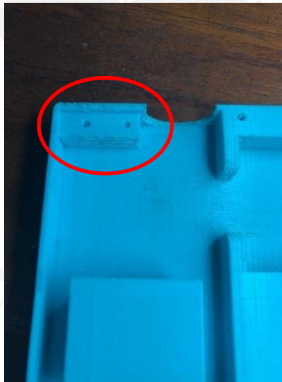
Gambar 4. 8 Kegagalan Hasil Print Kotak MCB Pertama
