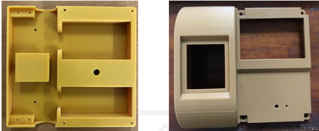
Gambar 4. 16 Hasil Print Desain Akhir Kotak MCB
