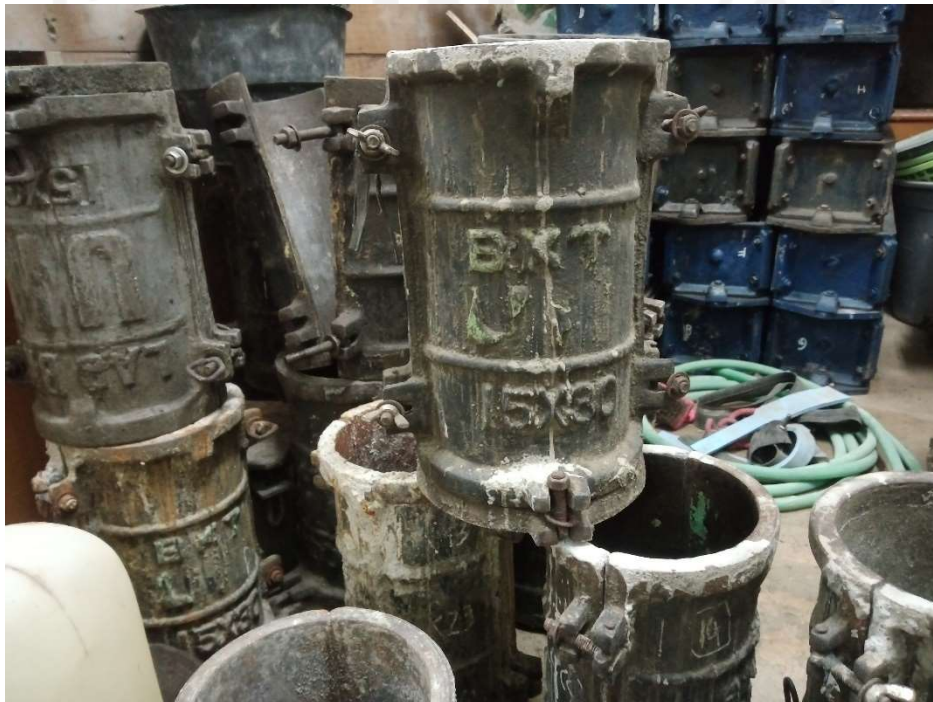
Gambar L-2.6 Cetakan Benda Uji
