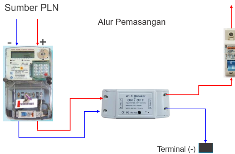
Gambar 4. 39 Alur perancangan pada instalasi listrik
