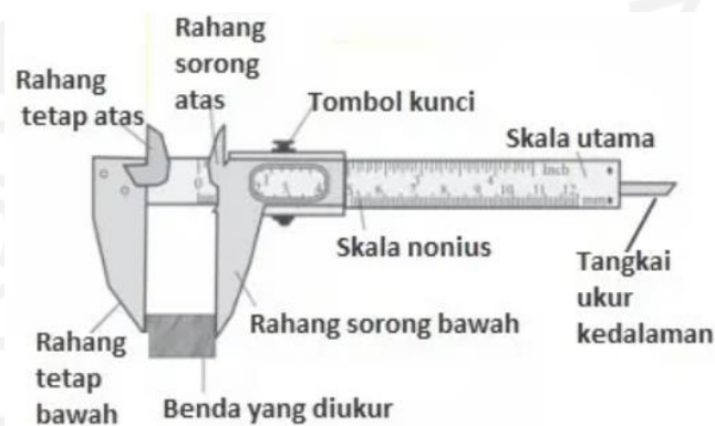
Gambar 2. 11 Bagian-bagian pengukuran dengan jangka sorong (Sumber: https://www.gamedia.com/literasi/alat-ukur-jangka-sorong/ )
