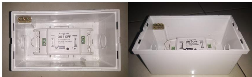
Gambar 1. 2 Posisi Smart Breaker saat dipasang pada box MCB
