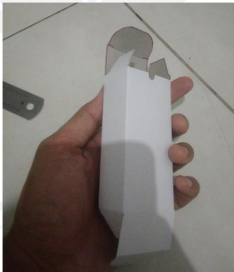
Gambar 4. 45 Penghubungan sisi pola yang diberi double tip .
