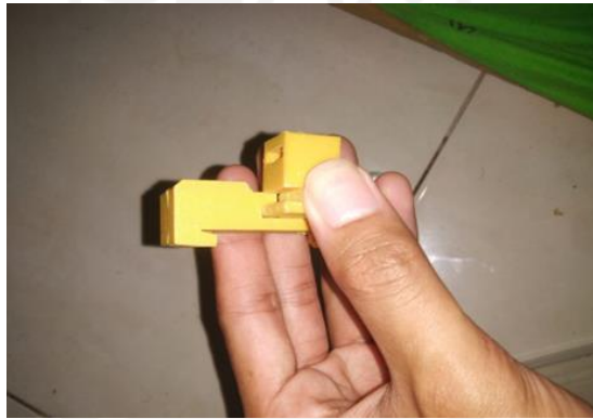
Gambar 4. 49 Part tidak bisa diassembly
