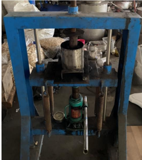
Gambar 8. Pengempaan Briket dengan Menggunakan Alat Kempa Hidrolik
