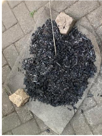
Gambar 3. Arang Eceng Gondok Hasil Pirolisis Eceng Gondok Kering
