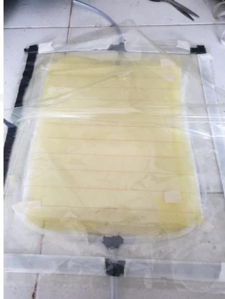
Gambar 3. 20 Memasukkan Bahan Kedalam Plastik Vakum
