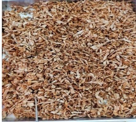
**Gambar 1 Batang Pisang setelah Proses Pengeringan**
