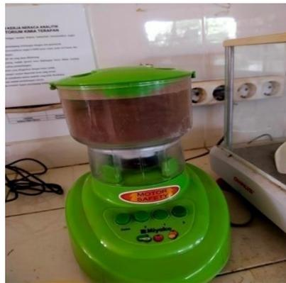
**Gambar 2. Proses Penghalusan Sampel Batang Pisang**
