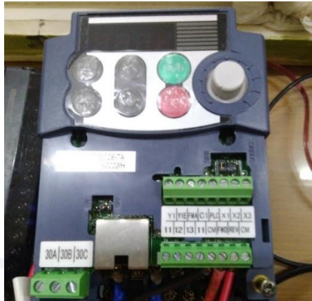
Gambar 3. 22 Inverter Fuji Electric FRENIC MINI
