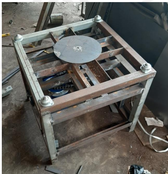
Gambar 3. 19 Proses Pembuatan Rangka Meja Putar
