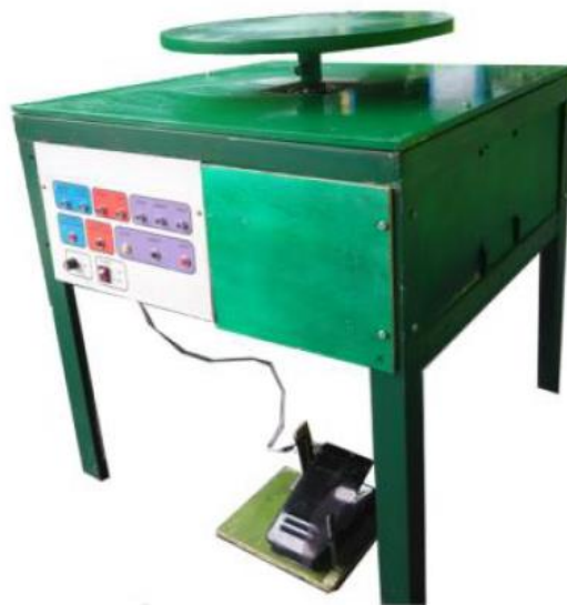
Gambar 2. 1 Meja Putar Alat Bantu Pembuatan Kerajinan Gerabah (Sumber : Ardiansyah, 2016)
