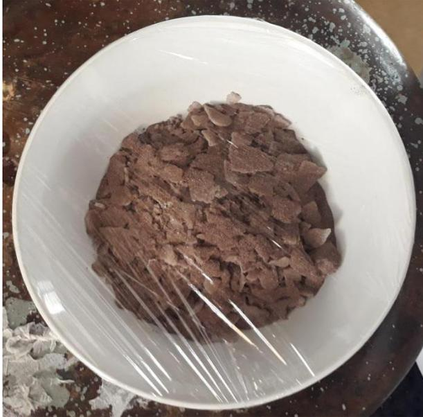
pelapisan NaOH dengan pasir zirkon sebelum dilebur
