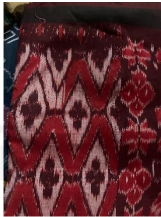
Gambar 4.20 Cacat Warna Pudar
