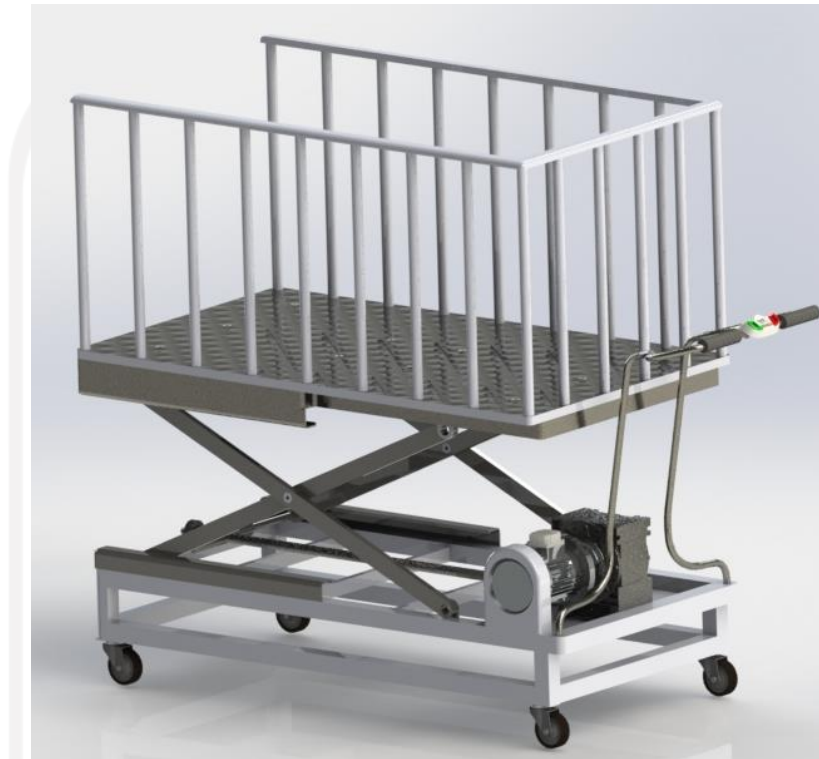
Gambar 4. 17: Tampilan isometrik visual desain alat angkut kain gulungan
