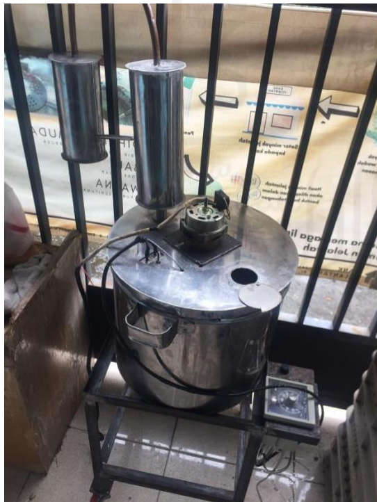
Gambar 3. 2 Desain Perencanaan Batch Reaktor menjadi biodiesel
