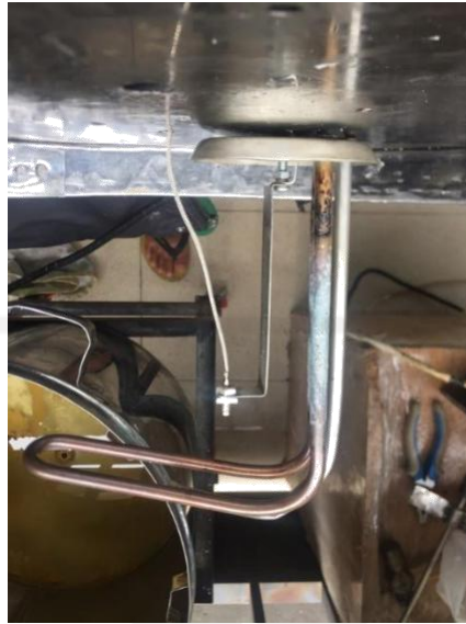
Gambar 4. 3 Heater berbentuk siku 90 o dengan panjang 10 cm
