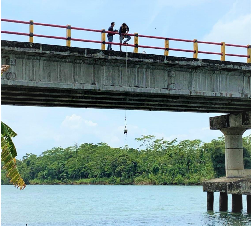
Gambar 3. 6 Pengambilan sampel sedimen sungai menggunakan dredge sampler Sumber: Dokumentasi Pribadi
