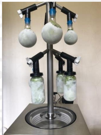
Alat freeze dry terpasang labu kaca berisi daun selada yang telah dibekukan di -80^{\circ}\text{C} selama 24 jam.
