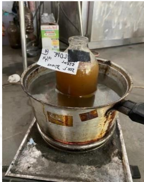
Gambar 19. Tar LDPE yang membeku dipanaskan dengan suhu 90 derajat C agar dapat mencair dan dijadikan bahan dalam pencampuran briket
