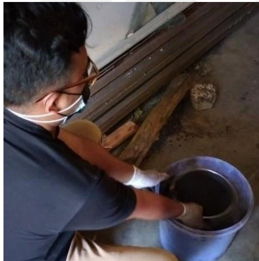
Gambar 17. Biocar yang sudah ditumbuk, dilakukan proses pengayakkan menggunakan skala 20 mesh agar dapat di gunakan untuk pencampuran bahan baku pembuatan briket.
