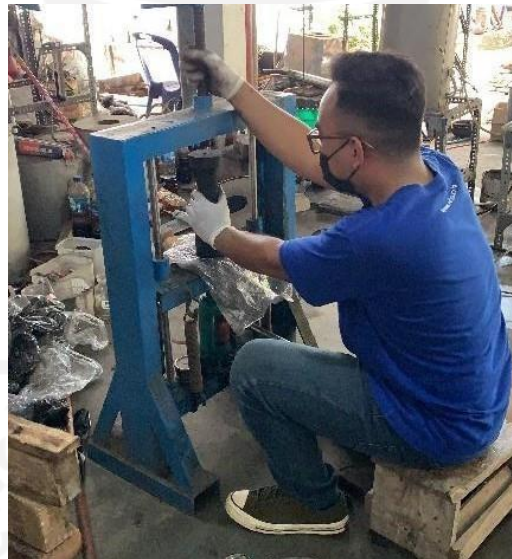
Gambar 21. Pencetakan briket menggunakan alat press hydraulic dengan ukuran diameter 5 cm dan tinggi 11 cm. Tekanan yang diberikan sebesar 150 \text{ kg/cm}^2
