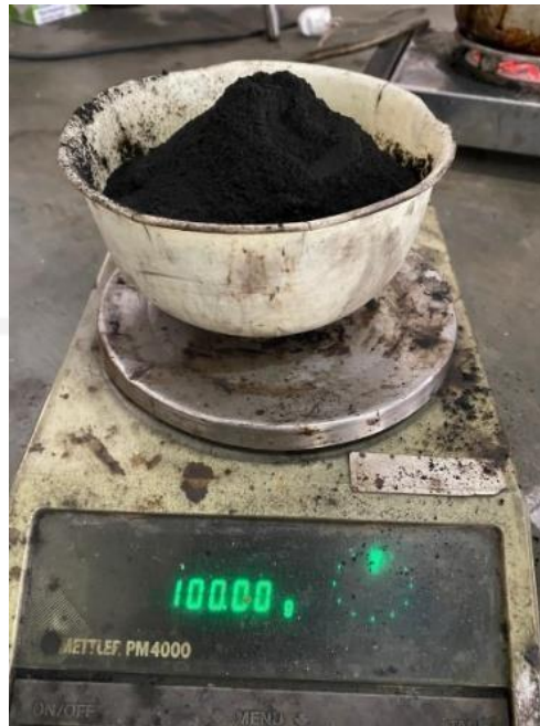
Gambar 18. Ini merupakan biocar yang telah melalui proses pengayakan berskala 20 mesh. Sampel ini sudah siap untuk digunakan menjadi bahan baku dalam pembuatan briket.
