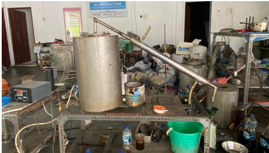
Gambar 8. Sampel yang sudah disiapkan, kemudian dilakukan proses pirolisis untuk dijadikan cairan tar yang berasal dari uap pirolisis yang dikondensasikan.
