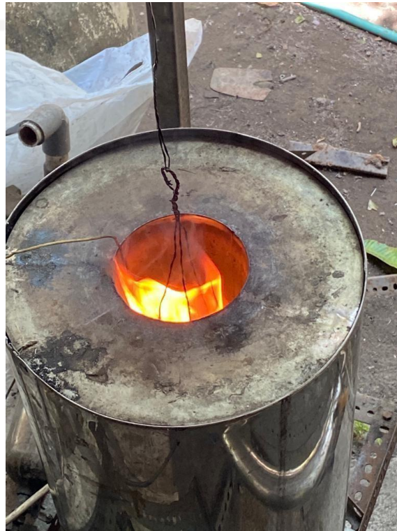
Gambar 24. Briket dengan variasi penambahan komposisi 100gr EG + 75 ml Tar LDPE, mengeluarkan api pada menit ke 15 dengan suhu optimal yakni sebesar 508 derajat C, suhu tersebut merupakan suhu paling tinggi diantara variasi lainnya.
