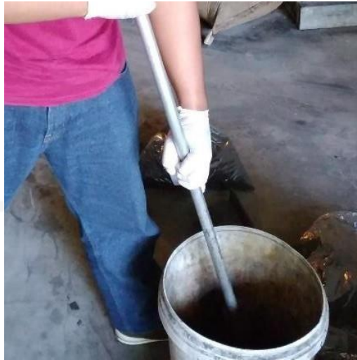
Gambar 16. Biocar ditumbuk disuatu wadah, dihaluskan untuk kemudian masuk ke proses pengayakkan
