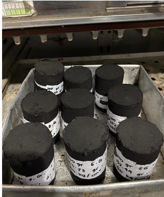
Gambar 22. Setelah briket dicetak maka dilakukan pengeringan menggunakan oven listrik dengan suhu 60 derajat celcius selama 3 jam.
