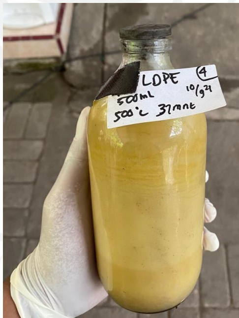
Gambar 9. Tar atau cairan minyak hasil pirolisis plastik LDPE yang membeku setelah ditinggal satu malam.
