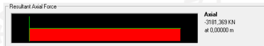
Gambar 5.28 Gaya Aksial Tekan Maksimum Batang Diagonal
