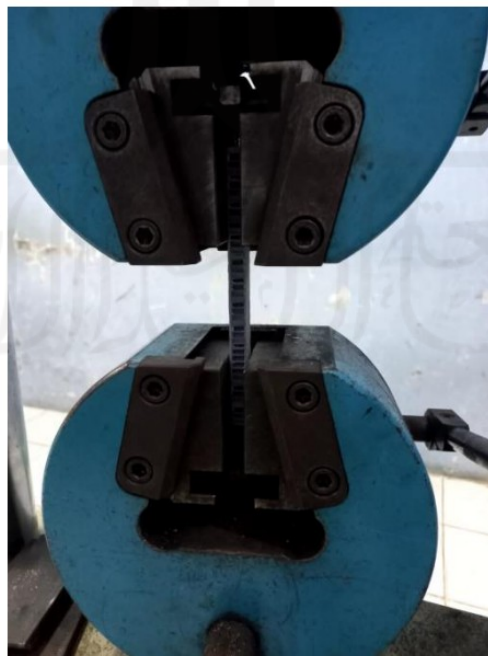
Gambar 3. 24 Proses Pengujian Tarik
