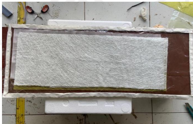
Gambar 3. 22 Lapisan susunan komposit sandwich
