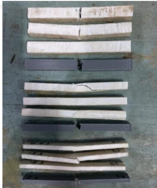
Gambar 4. 2 spesimen uji setelah pengujian bending
