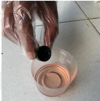
Gambar 3. 25 Pencampuran Resin dan Katalis
