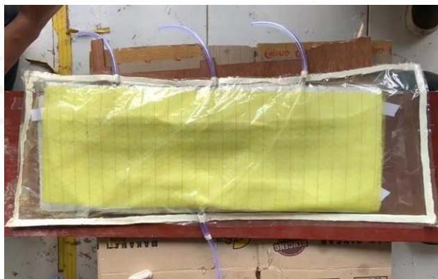
Gambar 3. 24 Memasukkan susunan komposit kedalam plastik
