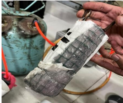
Gambar 3. 4 Hasil filter setelah terkena cairan resin
