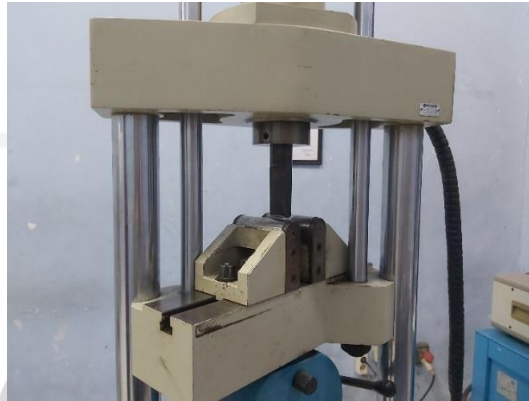
Gambar 3. 37 Bagian Uji Bending Mesin UTM
