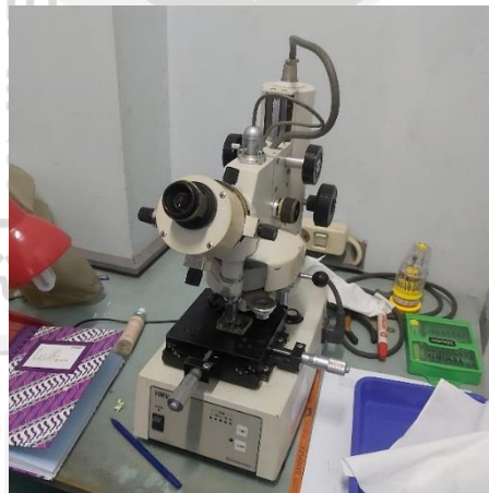
Gambar 3. 43 Alat Uji Kekerasan Shimadzu HMV M3
