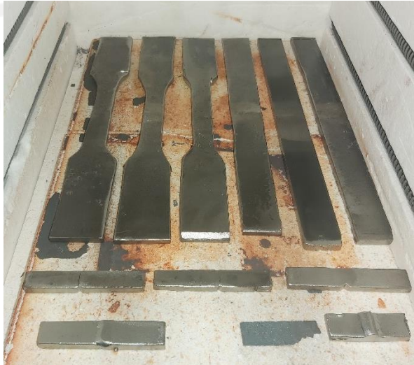
Gambar 3. 29 Posisi Spesimen dalam Furnace
