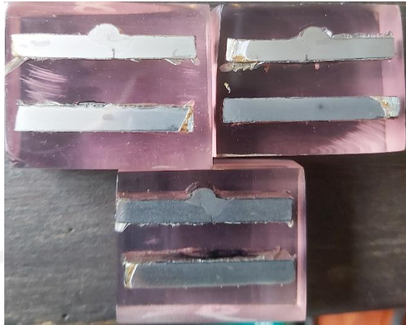
Gambar 3. 42 Spesimen Uji Struktur Mikro, Makro, dan Kekerasan
