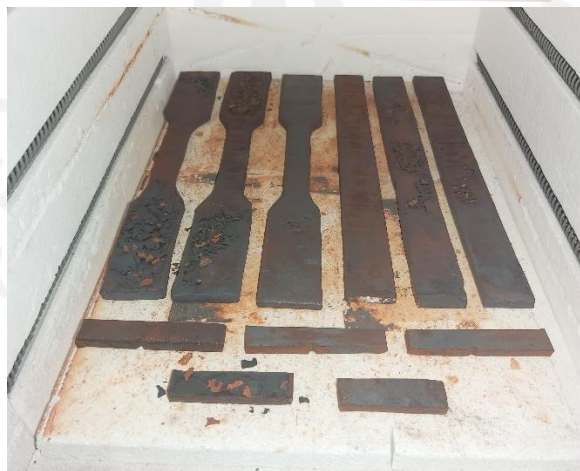
Gambar 3. 30 Spesimen setelah Annealing
