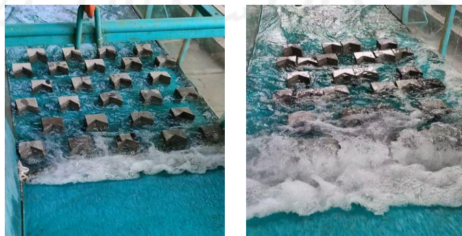
Gambar 5.4. Aliran Dengan Baffle Blocks pada bukaan 2 dan 3
