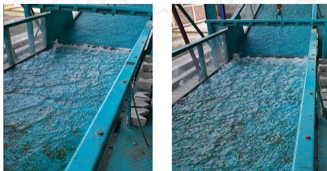
Gambar 5.1. Aliran Tanpa Baffle Blocks pada bukaan 2 dan 3
