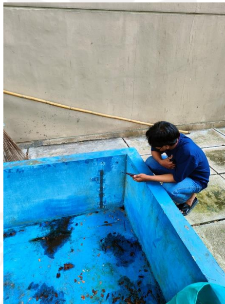
Gambar L 3.2 Pengambilan Waktu Kolam Tampung Tiap Kenaikan 5cm
