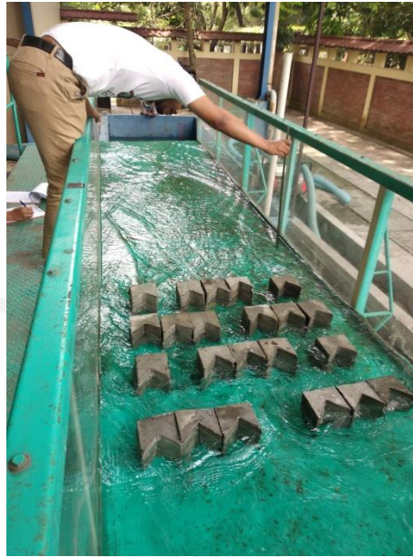
Gambar L 3.1 Pengukuran Tinggi Aliran
