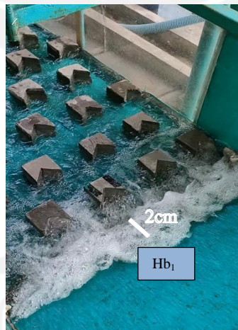
Gambar 5.6. Titik Pengambilan Kedalaman Hulu ( h_1 )
