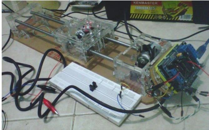
Gambar 3 - 5 Bentuk Nyata Simulator Crane Berdasarkan Perancangan Yang Telah Dilakukan.
