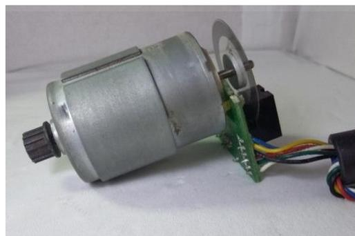
Gambar 3 - 8 Motor DC Mabuchi RS-385PH dengan enkoder 448 AB phase.
