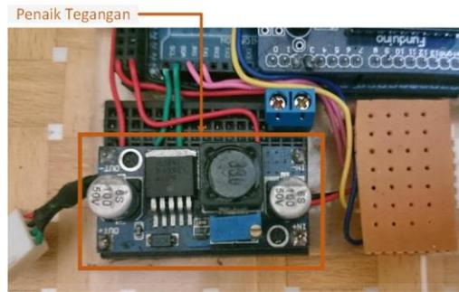
Gambar 3 - 30 Instalasi Penaik Tegangan Enkoder Posisi Ayun.
