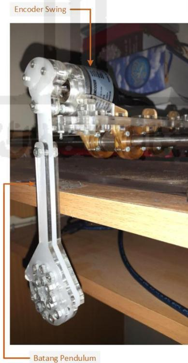
Gambar 3 - 28 Pemasangan Batang Ayun Pada Enkoder Posisi Ayun.
