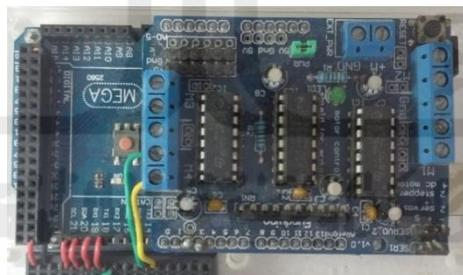
Gambar 3 - 22 Pemasangan Motor *Shield* ke Papan Arduino.
