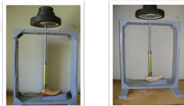
Gambar 2- 4 Proses Uji Dorsifleksi SACH Foot dan NEW Foot [8]
