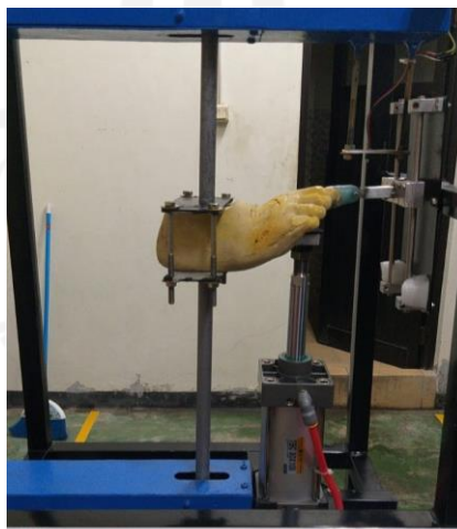
Gambar 4- 30 Proses Pengujian Dorsifleksi Produk Hasil Penelitian 3
