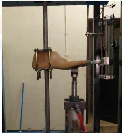
Gambar 4- 26 Proses Pengujian Dorsifleksi Produk B
