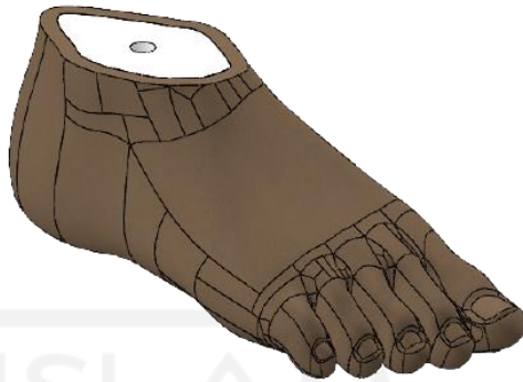
Gambar 4- 2 Assembly Core Cavity dan Anatomi Telapak Kaki
