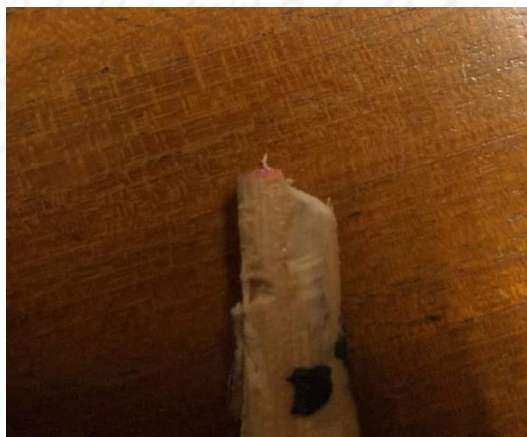
Gambar 4- 50 Spesimen Dari Pengujian Pin On Disc Gagal
