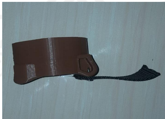
Gambar 4- 7 Pemasangan Belting Dengan Core Cavity
