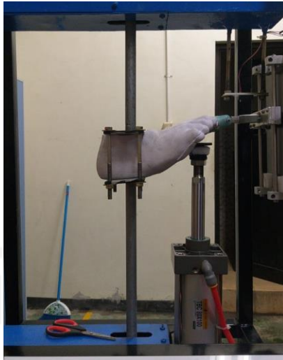
Gambar 4- 28 Proses Pengujian Dorsifleksi Produk Hasil Penelitian 1
