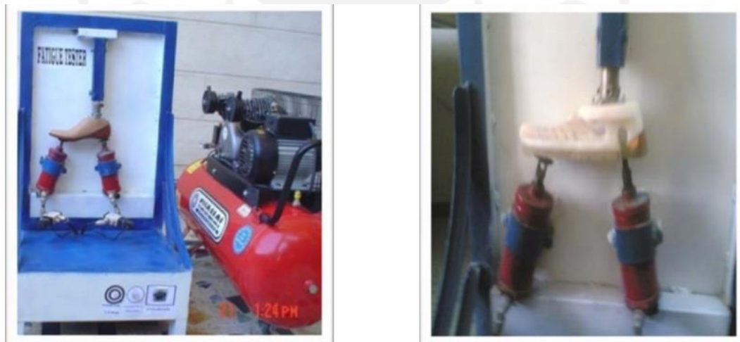
Gambar 2- 5 Proses Uji Lelah SACH Foot dan NEW Foot [8]
