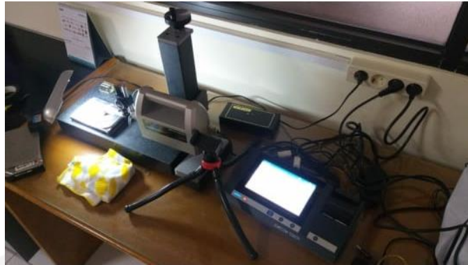
Gambar 4- 36 Alat Pengujian Kekasaran Permukaan
