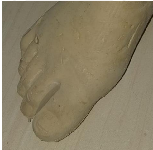
Gambar 4- 47 Defect Pada Telapak Kaki Palsu Produk 2
