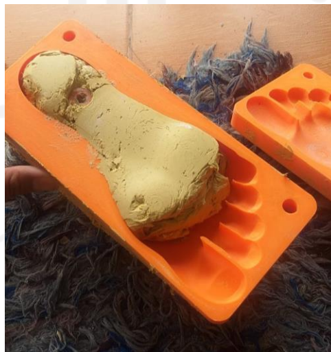
Gambar 4- 46 Defect Pada Proses Pembuatan Telapak Kaki Palsu
