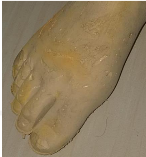
Gambar 4- 48 Defect Pada Telapak Kaki Palsu Produk 3
